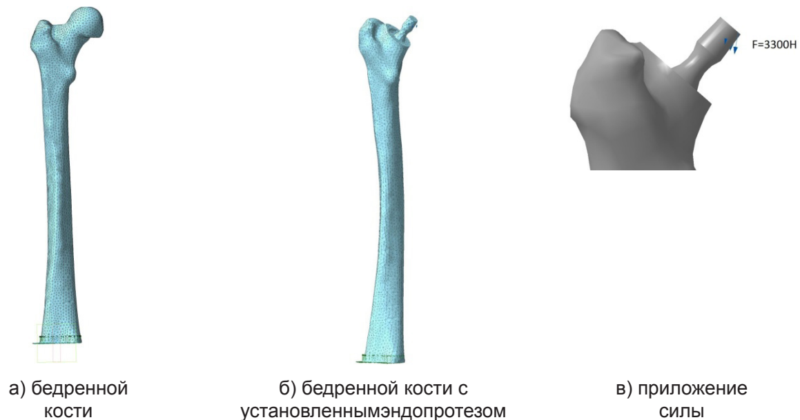
Рисунок 3 - Конечно-элементная сетка моделей
